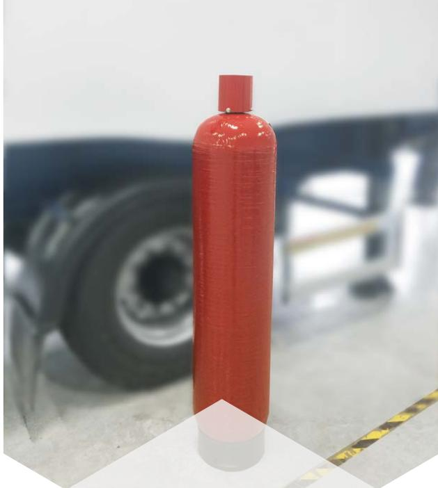
Баллоны изготавливаются на рабочее давление: 4, 6.5, 15 МПа и вместимостью от 40 до 200 л. Баллоны предназначены для хранения под давлением огнетушащих составов, воды, водных растворов, хладонов и др.
