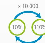
Проверка циклической долговечности баллона
