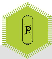
Баллон Тип 3 имеет алюминиевый лейнер и не нуждается в наличии постоянного остаточного давления, что позволяет его опорожнять полностью в отличие от баллонов Тип 4
